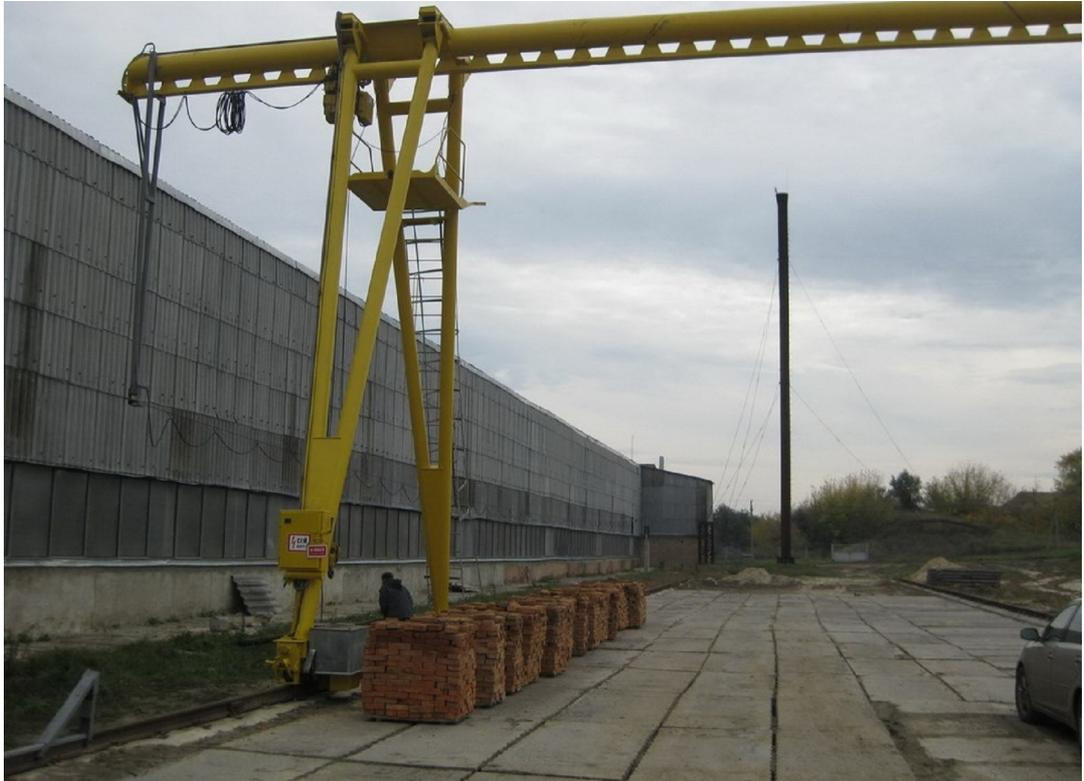
Вдоль печного отделения оборудована из плит площадка готовой продукции. Смонтирован и введен в эксплуатацию кран козловой ККТ-5
