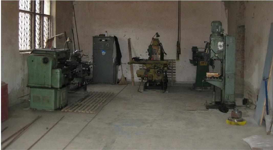
Ремонтный участок укомплектован токарным, фрезерным и сверлильным станками
